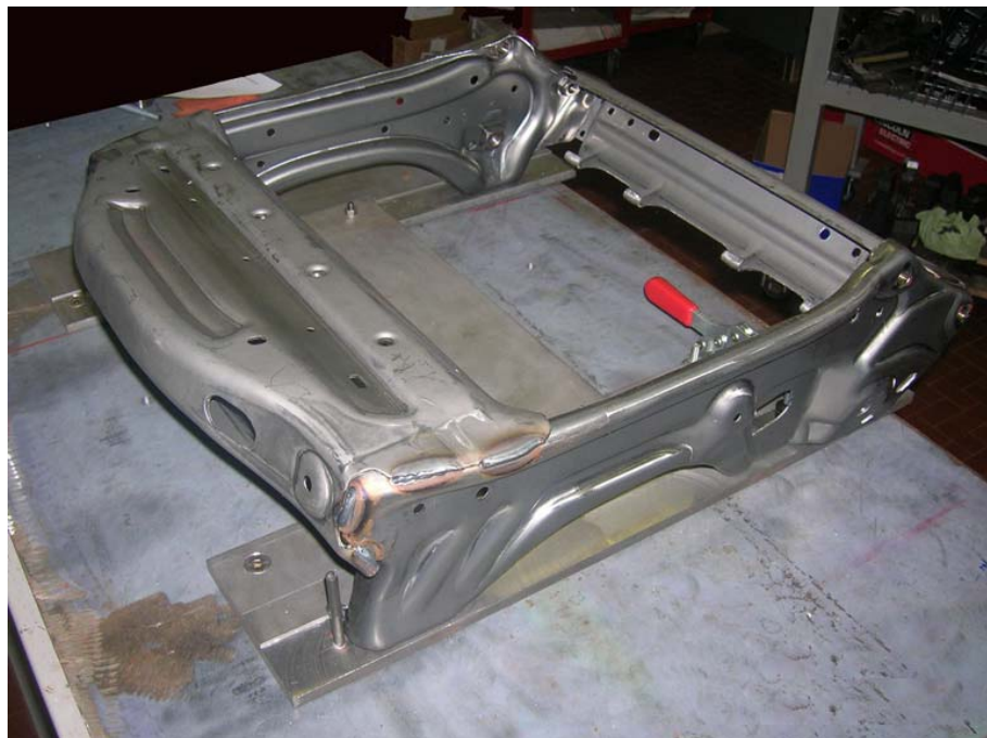
TRAVERSA POSTERIORE Acciaio S355
