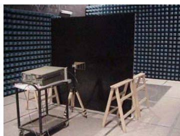
Pannello di legno con vernice conduttrice. Pannello di legno con mattonelle in elastomero addittivato con nanofibre di carbonio.
