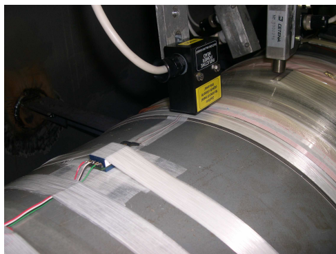
Figura 2: Nuovo torsionmetro induttivo
